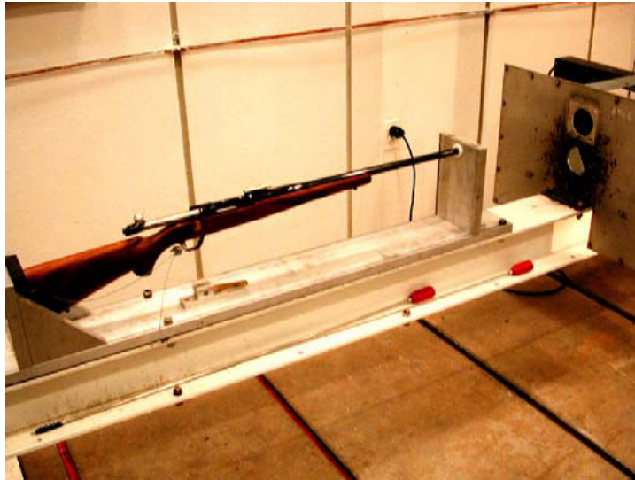
ภาพที่ 8 แสดงภาพอาวุธปืนที่ใช้ในการทดลอง Ruger M70 bolt action rifle
