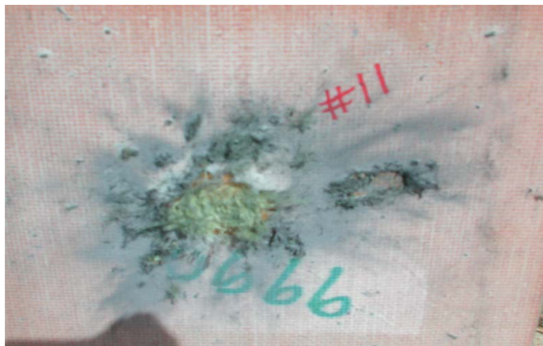
ภาพที่ 16 แสดงรูทางออกที่เกิดจากกระสุนเข้าปะทะที่บริเวณด้านหลังของแผ่นเคปเลอร์
