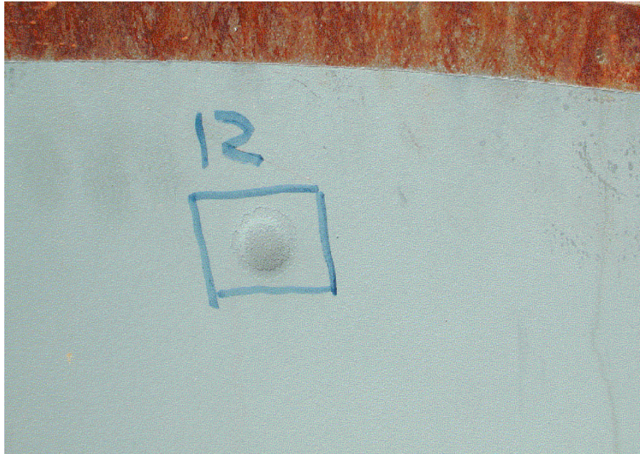
ภาพที่ 13 แสดงรอยนูนที่ปรากฏบริเวณด้านหลังของแผ่นเหล็กที่มีแผ่นเกราะเคลปาร์วางกัน จากภาพที่ 12
