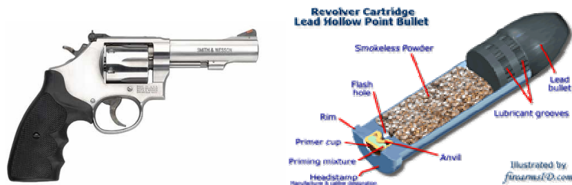
รูปที่ 11 ปืนพกแบบลูกโม่ขนาด .38 SPECIAL (LRN) revolver cartridges
