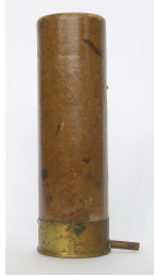
รูปที่ 6 แบบของขนาดท้ายกระสุนปืน (แก๊ป) ของกระสุนปืนแบบ PinFire
