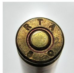
รูปที่ 5 เครื่องหมายที่งานท้ายกระสุนปืนเล็กกล ขนาด .223 (5.56 มม.)
