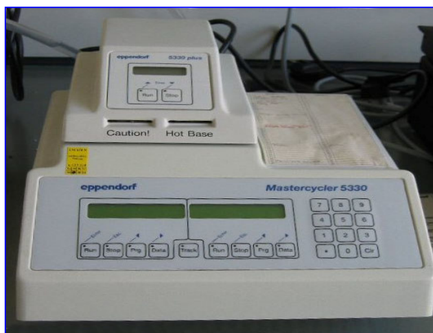
ภาพที่ 2.6 เครื่อง Thermal cycler หรือ PCR machine (ที่มา http://www.molecularstation.com )
